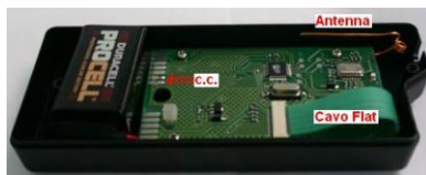
Figura VII: Circuito elettronico Televoter - Ponticello riavvio microcontrollore
